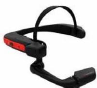
O *SmartGlass* foi utilizado na auditoria referente à Manutenção e Inspeção de Equipamentos Submarinos, na plataforma P-57, sendo verificado que é possível a realização de testes conclusivos utilizando o equipamento. Foi observada uma ótima conectividade de dados e de resolução das imagens, e razoável performance das interfaces e funcionalidades existentes.
